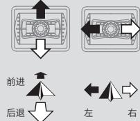
2. “云台俯仰控制滚轮”，可控制相机的俯仰拍摄角度。
