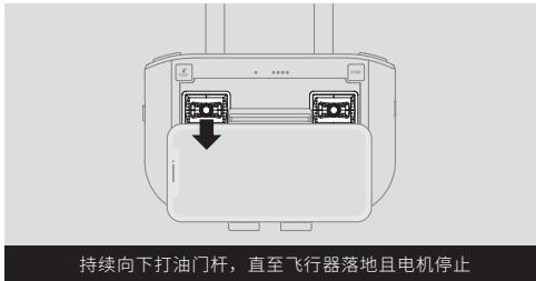
持续向下打油门杆，直至飞行器落地且电机停止
