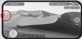
点击拍摄界面的“降落”图标，飞机将自动降落
