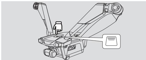
\* 注意：不需要手动旋转电机，起飞前电机角度将自动就位。
