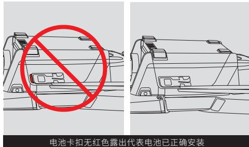
电池卡扣无红色露出代表电池已正确安装
