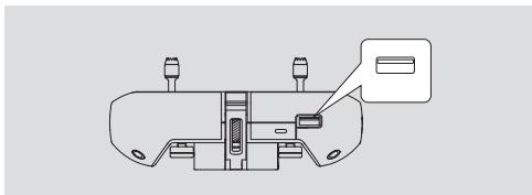
■ 长按电源键 2 秒，听到开机声后，遥控器开机成功
